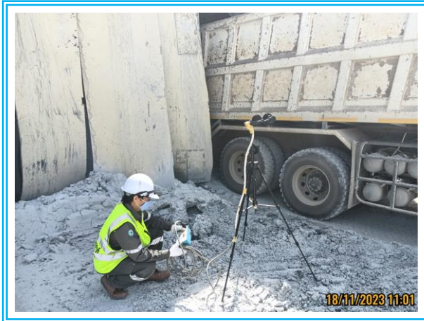
รูปที่ 4.3-5 แสดงการตรวจวัดค่าความทึบของฝุ่นละออง (Opacity) บริเวณยู่รับหิน วันที่ 18 พฤศจิกายน 2566
