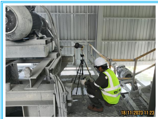
รูปที่ 4.3-7 แสดงการตรวจวัดค่าความทึบของฝุ่นละออง (Opacity) บริเวณปากโมชั้นที่ 2 วันที่ 18 พฤศจิกายน 2566
