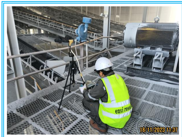
รูปที่ 4.3-8 แสดงการตรวจวัดค่าความทึบของฝุ่นละออง (Opacity) บริเวณตะแกรงคัดขนาด วันที่ 18 พฤศจิกายน 2566
