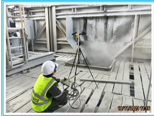
รูปที่ 4.3-6 แสดงการตรวจวัดค่าความทึบของฝุ่นละออง (Opacity) บริเวณปากโมหินใหญ่ วันที่ 18 พฤศจิกายน 2566
