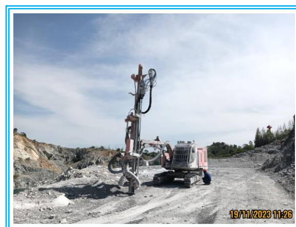
รูปที่ 3-8 เครื่องเจาะรูระเบิดที่มีอุปกรณ์เก็บฝุ่น
